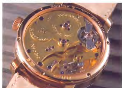
Series 2 的機芯夾板以特別的整飾工序 (frosting) 處理，效果均勻，有別於瑞士慣常採用的日內瓦條紋，黃金套筒以螺絲鎖緊，精鋼的表面以黑色拋光處理。Roger 表示，以人手修飾部件至最高水準，是最花時間和最具挑戰性的事，「到底製錶師是有個性和心情的，有別於機器。」
