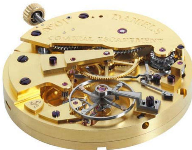
Механизм с коаксиальным спуском в «юбилейных часах» George Daniels Anniversary Watch
